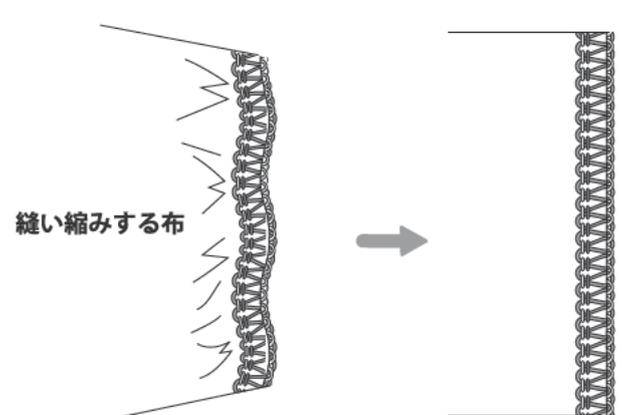
生地の縮みを防ぐには、『伸縮調節ダイヤル』を『のびる』方向へ回し調節します。
