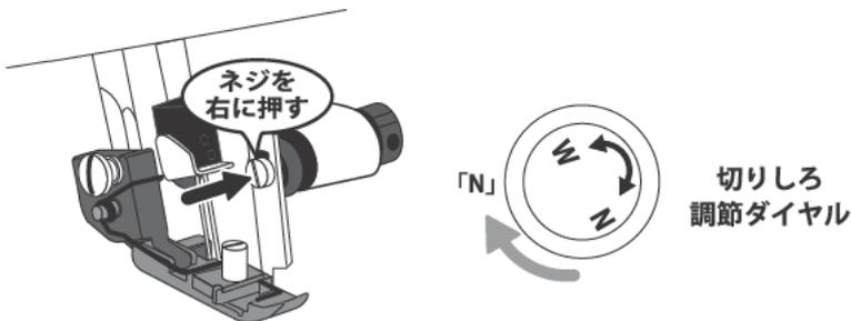
5 『上メス止めネジ』を右側に押しながら、『切りしろ調節ダイヤル』を『N』方へ回し切り幅を狭くします。(P23参照)
