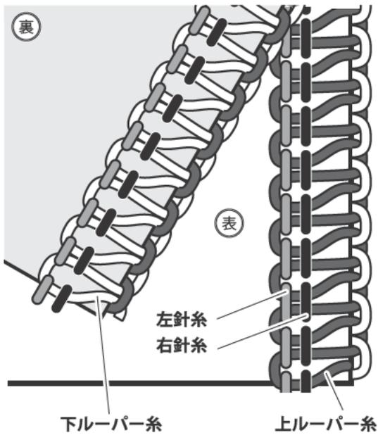
糸調子は生地の種類や糸の太さによって、糸の調節が必要です。試し縫いで縫い目を確認し、それぞれの『糸調子ダイヤル』で調節してください。
