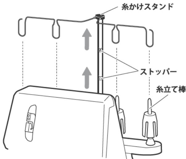
『糸かけスタンド』先端のプラスチック部を持ち最上位まで引き延ばします。
