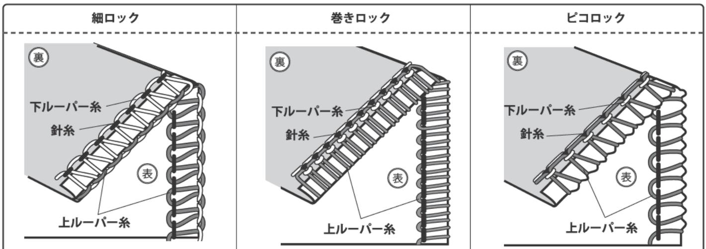
糸調子が正しいと、上図のようになります。縫い目を確認しながら、『糸調子ダイヤル』で糸調子を調節します。
