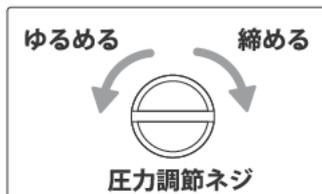
圧力調節ネジを強く締める
