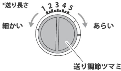
3 『送り調節つまみ』は細ロックと巻きロックは1.0~2.0mm、ピコロックは3~3.5mmに合わせます。(P22参照)
