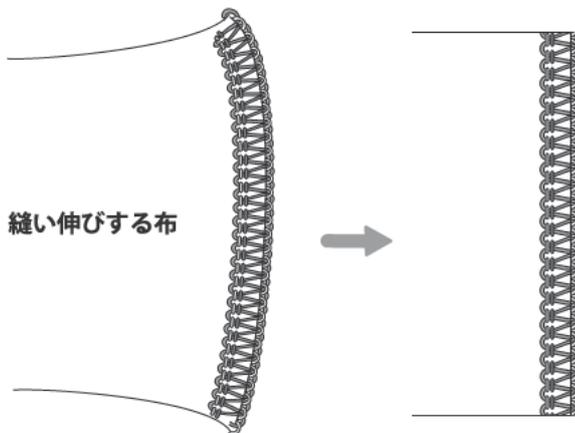
生地の伸びを防ぐには、『伸縮調節ダイヤル』を『ちぢむ』方向へ回し調節します。
