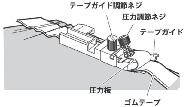
1 ゴム押えのテープガイド『調節ネジ』と『圧力調節ネジ』をゆるめ、圧力板の下にゴムテープを挟みます。
