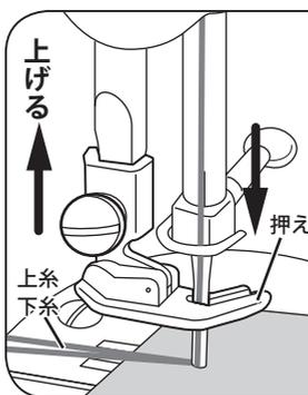
2. 押えを上げ、『はずみ車』を手前に回して縫い始める位置に針を刺します。
