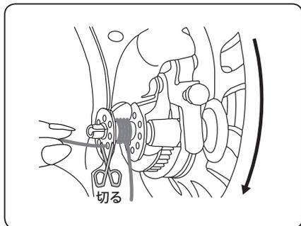
9. 糸の端を持ち、『はずみ車』を手前に回して『ボビン』に7～8回ほど糸を巻き、糸を切ります。
