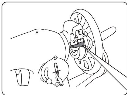
4. 『ボビンの切り込み』と『下糸巻き軸バネ』を合わせます。
