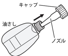
1. 中の油がこぼれないように『キャップ』を開けて『ノズル』を取り出します。
