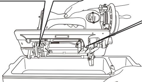
ミシンの底部に油をさすときは見えるようにミシンを倒します。
