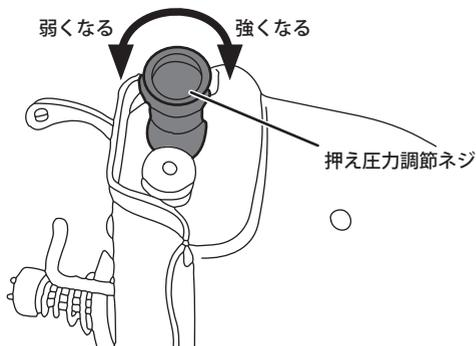
布の種類や厚さによって『押え圧力調節ネジ』を回して調節します。
