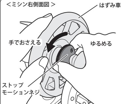
3. 片手でしっかり『はずみ車』を押え、『はずみ車』中央の『ストップモーションネジ』を矢印方向(反時計回りに30~60°回転)に回してゆるめます。
