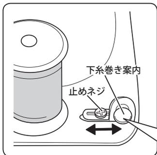
※ 『ボビン』の糸巻きが片寄る場合は、止めネジをゆるめ、『下糸巻き案内』の位置を調節してください。
