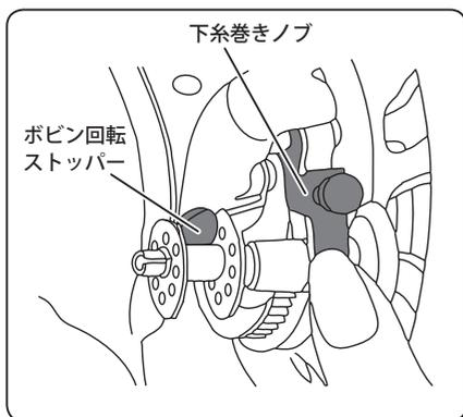
6. 『下糸巻きノブ』を押し付け、『ボビン回転ストッパー』をセットします。
