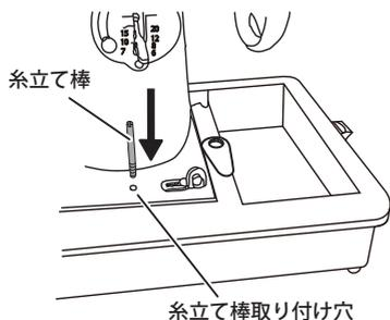
1. 付属の『ドライバー』を使用し『糸立て棒取り付け穴』に『糸立て棒』を奥までねじ込みます。
