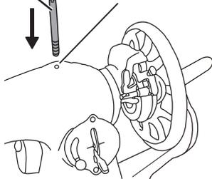
1. 付属の『ドライバー』を使用し『糸立て棒取り付け穴』に『糸立て棒』をねじ込みます。
