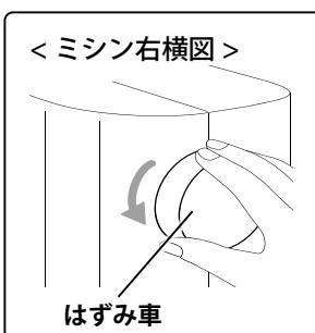
【2】『はずみ車』を手前に1回転させ針を上げると、下糸の輪が引き出されます。
