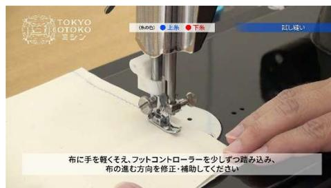
布に手を軽くそえ、フットコントローラーを少しずつ踏み込み、布の進む方向を修正・補助してください
