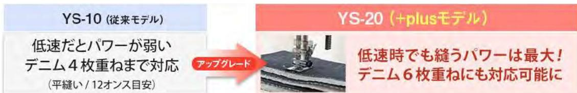
ミシン内部に電子制御を搭載し、低速で縫う場合でも力強く縫い進めることができます。またデニム 6 枚重ねまで縫うことができ、裾上げなどの段差 2 枚→6 枚→2 枚の段縫いも可能になりました(※送り長さ最大の場合)。
