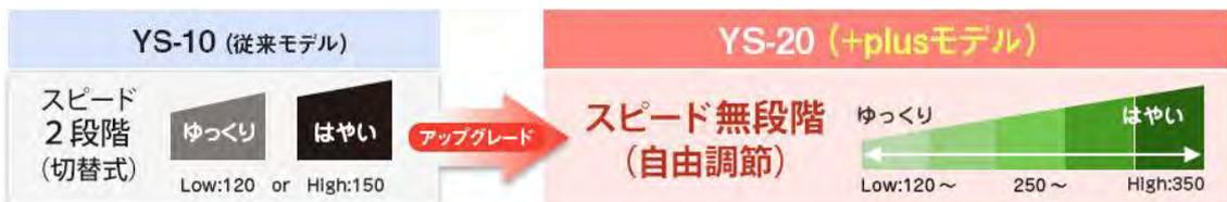
初心者でも安心して縫えるように、基本の縫い速度は一般的なミシンよりも「ゆっくり」。ただ、物足りなさを感じるユーザーの声をもとにスピードコントロールの幅を拡大させ、さらに無段階で自由に速度調節ができるようになりました。
